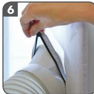
6 Aprire la finestra quanto basta e far uscire il tubo di scarico tramite la cerniera dell'AirLock 100/200.
