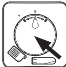
2. Вставьте две батарейки AAA, входящие в комплект поставки, в отсек для батареек. При установке батареек соблюдайте полярность (+/-), указанную в отсеке для батареек. Если батарейки вставлены правильно, на дисплее на 3 секунды загорятся все индикаторы. Затем термогигрометр автоматически перейдет в стандартный режим работы.
